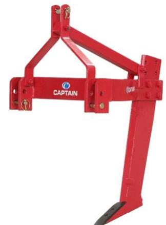
El arado subsolador está diseñado para fisuración del suelo rompiendo capas compactadas sin que se produzca la inversión del perfil. También se usa en la construcción de túneles de drenaje en terrenos arcillosos con problemas de acumulación de agua en el perfil de suelo. Para ello, en la parte posterior de la bota se instala un balín tipo topo unido por una cadena para lograr el efecto de formación de túneles de drenaje.
