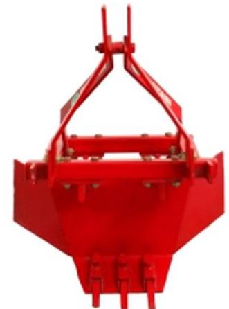
Las zanjadora en agricultura, se emplean para hacer y mantener canales o acequias en redes de riego y zanjas para la inserción de plantas. Las zanjadoras también son apropiadas para el mantenimiento de los bordes de las carreteras.
